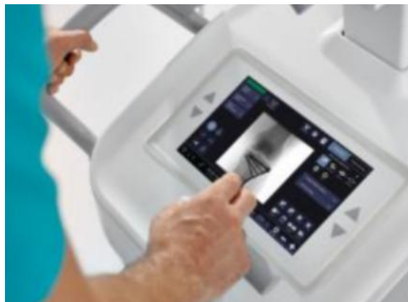
Figura 3: Painel de controle integrado no arco.
