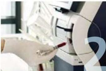
2 A entrada, com função de auto-limpeza, aspira automaticamente a amostra de uma seringa, um capilar ou um tubo de ensaio.
